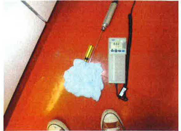
Kuvat 41 ja 42. Poikkeavaa kosteutta kellarin keittiön lattiassa.
